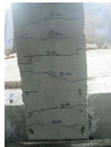
(c), (d) and (e) Crack measurements
