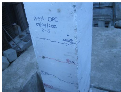
(c), (d) and (e) Crack measurements
